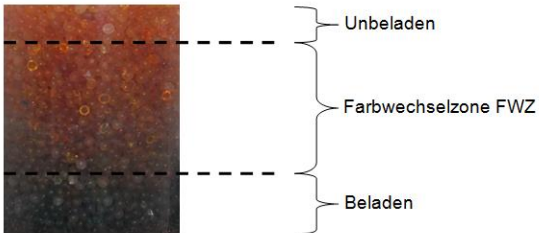
Abbildung: Farbverlauf in einer Schüttung aus Silicagel E Orange Grün.
