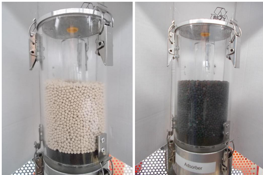
Abbildung: Getestete Adsorber, beide im beladenen Zustand (links: Molekularsieb, rechts: Silicagel).
