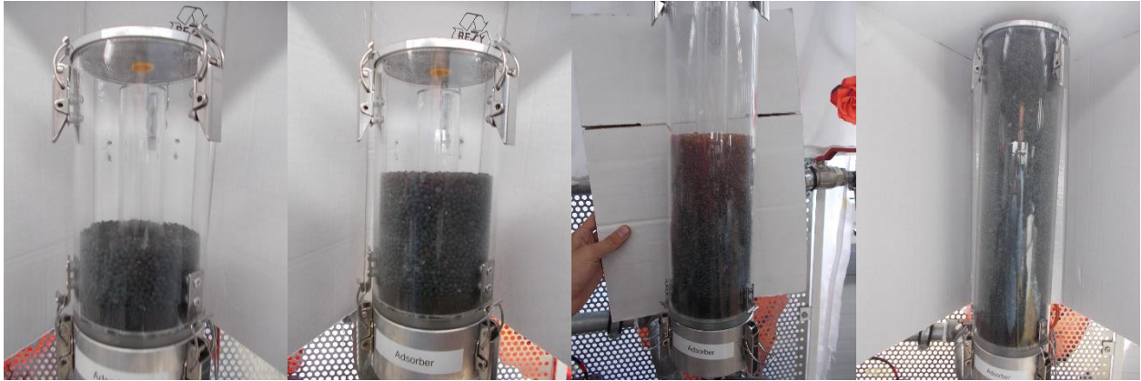
Abbildung: Getestete Mengen Silicagel (von links: 0,25kg, 0,5kg, 1kg, 2kg)
