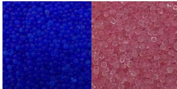
Abbildung: Silicagel mit dem Feuchtigkeitsindikator Cobaltdichlorid (links ohne und rechts mit Wasser).
