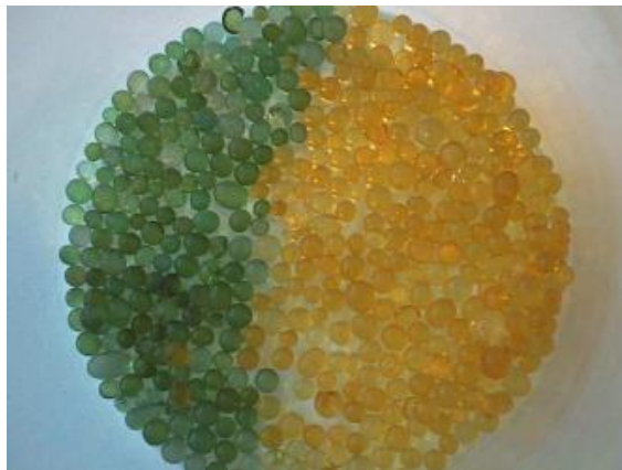
Abbildung: Silicagel mit dem Feuchtigkeitsindikator Kristallviolett (rechts mit und links ohne Wasser). 2
