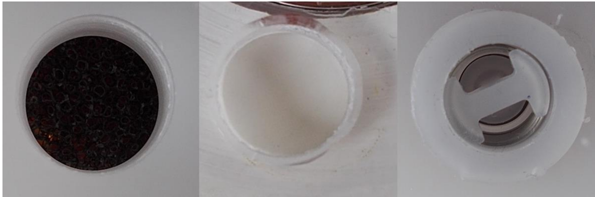
Abbildung: Öffnungen der Belüftungstrockner(links: Löcher; Mitte: Membran; Rechts: Ventil).
