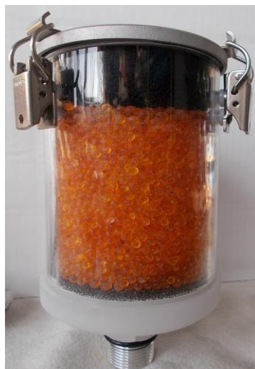
Abbildung: Eingesetzter Belüftungstrockner vV 210-PA mit 0,3kg Silicagel
