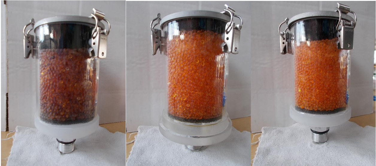
Abbildung: Adsorber im Test nach 50 Tagen (links: Löcher; Mitte: Membran; Rechts: Ventil).
