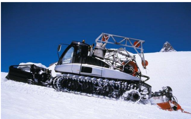
Abbildung 2: Pistenfahrzeug von Prinoth mit Anbaugeräten, hydraulisch betrieben. (Quelle: www.prinoth.com , vom 20.07.2019)
