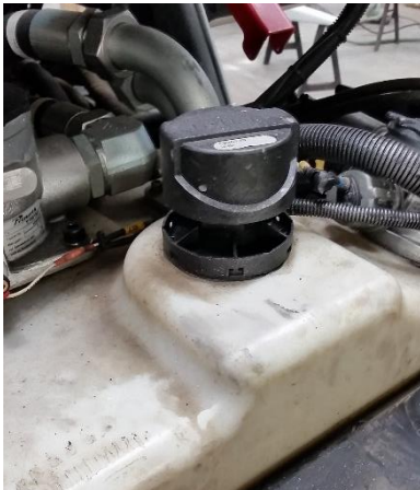
Abbildung 3: Hydrauliktank eines Pistenfahrzeugs.
