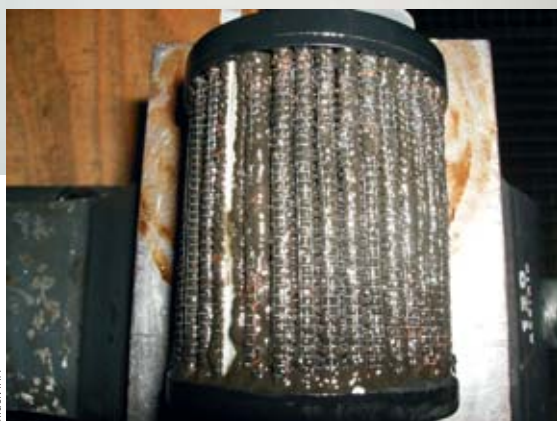
Die Schmutzaufnahmekapazität eines Filterelements (Beispiele rechts und links) ist ein wichtiger Kennwert für die Auswahl eines Filters.
