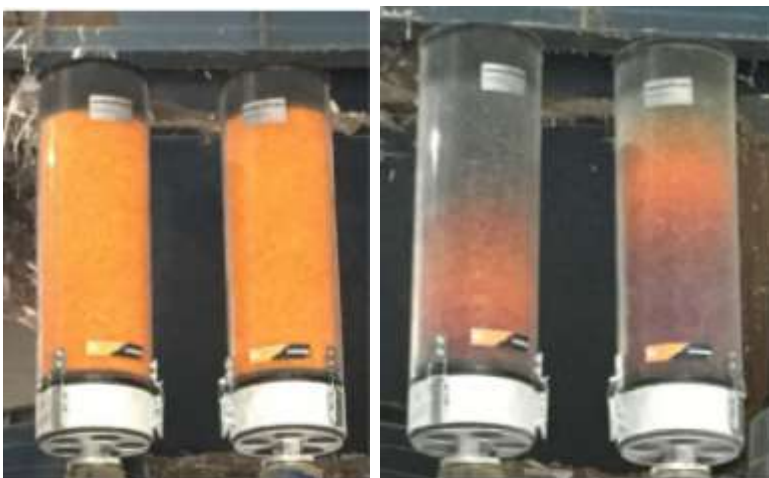
Abbildung 3: Adsorber bei der Installation (linkes Bild) und nach 16 Wochen (rechtes Bild)
